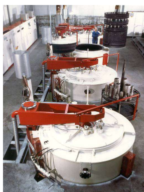
Obr. č. 4 a 5 – Soubor komorových a šachtových pecí pro technologii Corr-I-dur®
