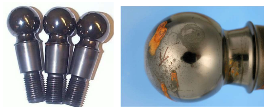
Obr. č. 2 - Příklad aplikace technologie Corr-I-dur® před a po korozním testu
